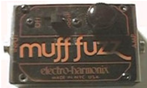
Links: De originele Muff Fuzz had een schuifschakelaar om het effect aan en uit te zetten.
