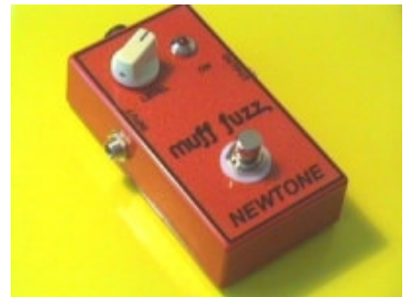
Rechts: Een hedendaagse versie is natuurlijk per voetschakelaar te bedienen (in true bypass) en heeft een status LED.
